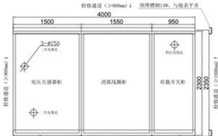
图20 组合柜基础图
